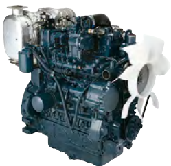
MOTOR V3800-DI-T-E3B Potencia: 99,2 HP (74,0 KW). Revoluciones: 2600 RPM. Peso Vacío: 288 Kg. N° Cilindros: 4.
